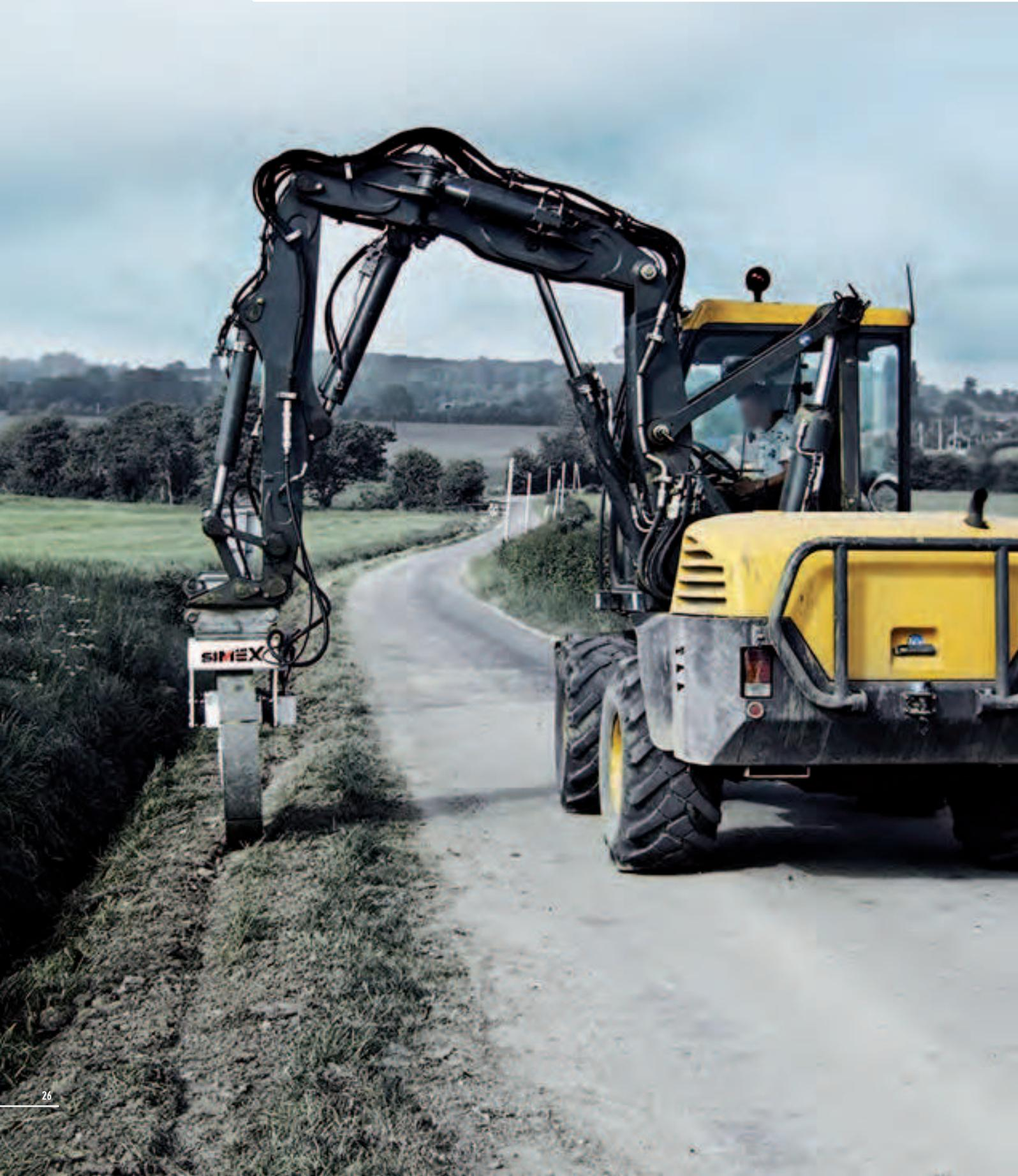
■ Conçues pour **compacter les fonds de fouille**, les roues de compactage vibrantes SIMEX CT garantissent un **fond homogène et bien compacté qui ne cède pas dans le temps**.
